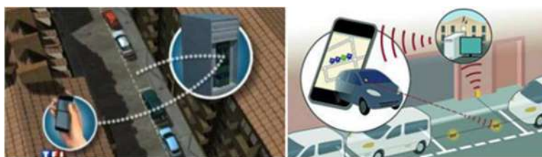
Figura 8.2 Schema di funzionamento del monitoraggio elettronico degli stalli di carico e scarico
